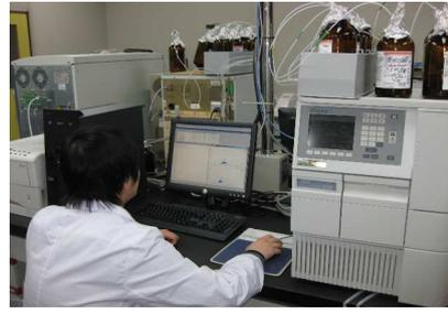
理化学検査(液体クロマトグラフィー質量分析装置)
