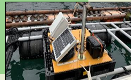
テレメータシステムによる 24時間自動連続観測
