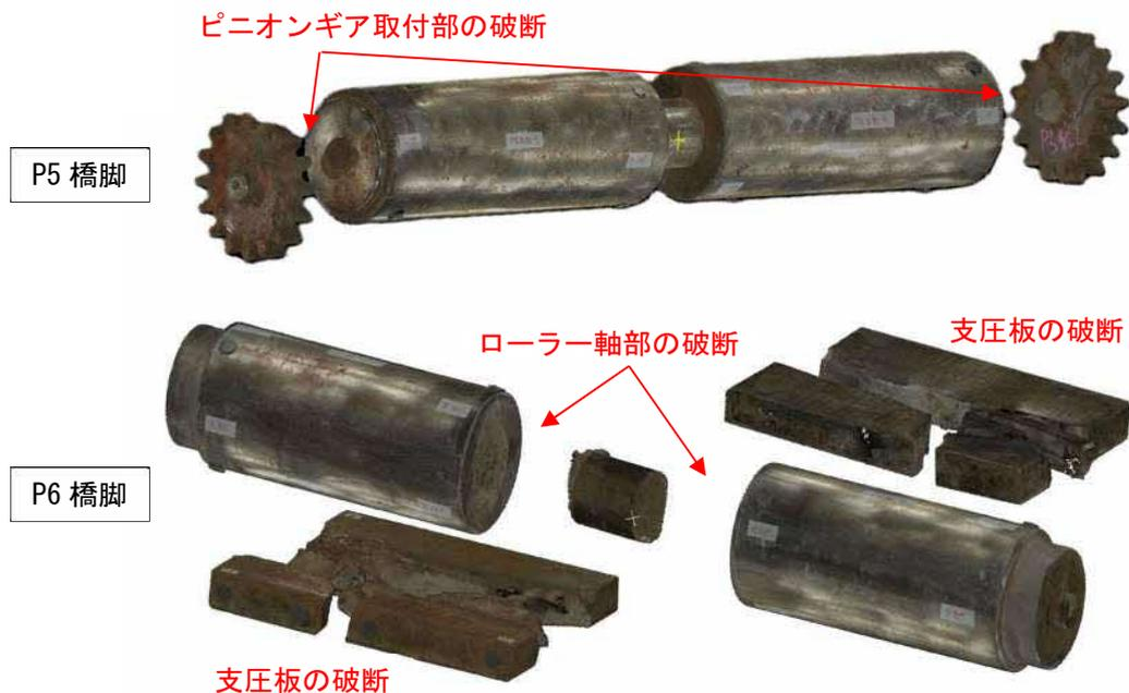
図 2.4-1 支承部材の損傷状態
