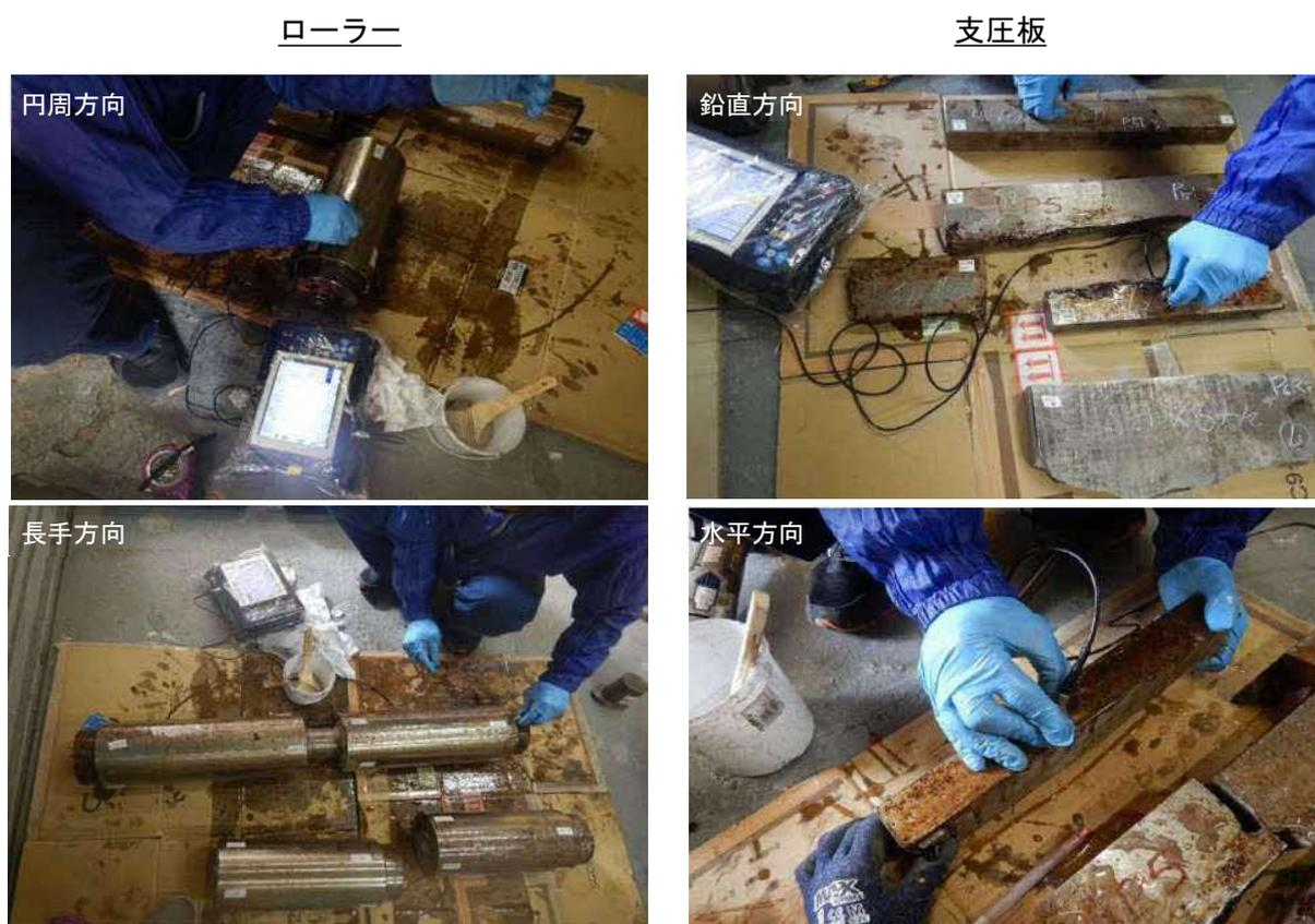
図 2.3-6 超音波探傷試験実施状況
