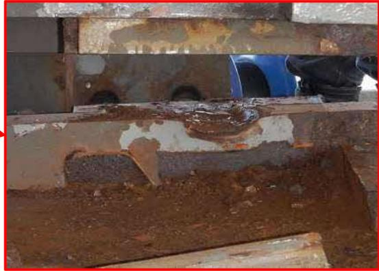
図 2.4-3 ローラーとガイドとの接触の痕跡
