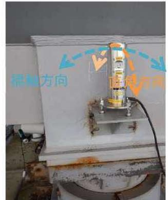
図 2.6-7 桁伸縮量 (橋軸方向ひずみ) および傾斜計測概要
