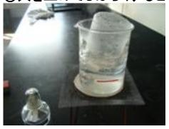
⑤ピーカーの中にたまった水蒸気が冷えて水に戻る
