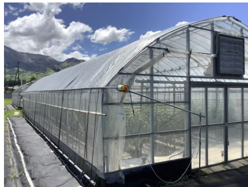
外張りの自動開閉装置
