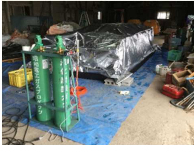
高濃度二酸化炭素ガス充填装置の設置状況
