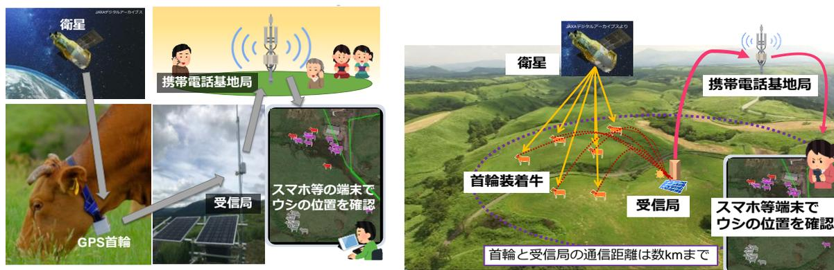
図1 首輪型 GPS 機器による放牧牛の位置把握の概念図
