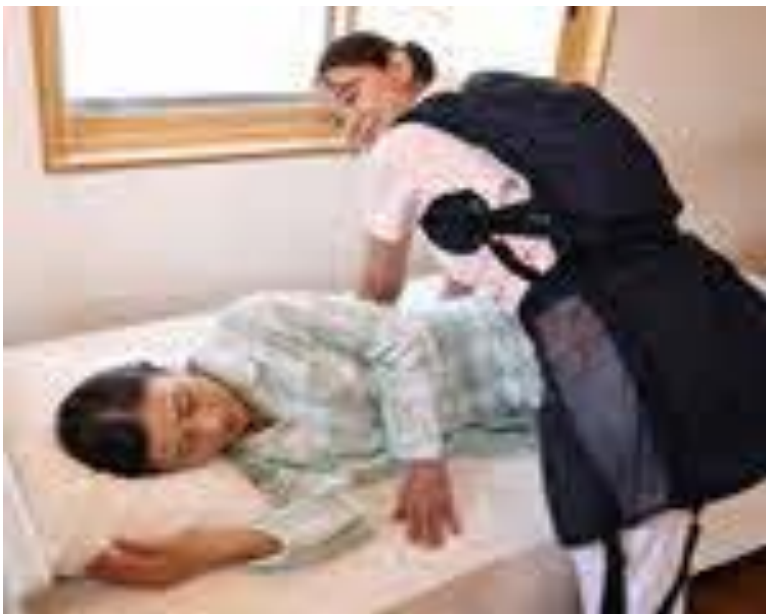
装着者の動きを検知し、モーターでアシスト力を調整
