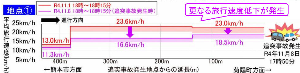
▲追突事故発生に伴う更なる旅行速度低下状況(例:地点①(国体道路)) 資料: ETC2.0プローブデータ(国土交通省提供)(R4.11.1、R4.11.8)
