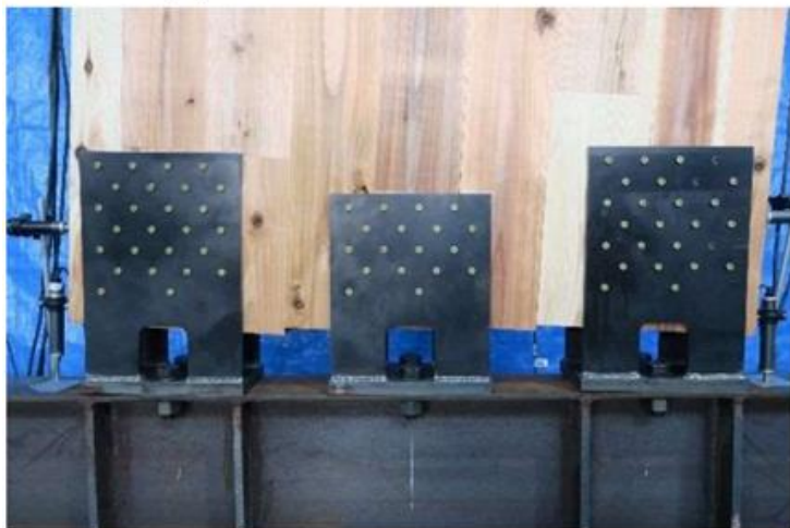
(3)最大変形時 下梁接合部の浮き上がり
