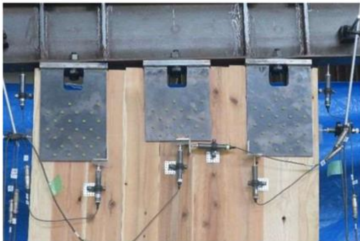
(2)最大変形時 CLT のせん断破壊
