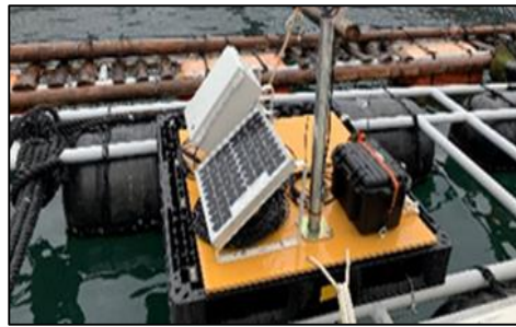
テレメータシステムによる 24時間自動連続観測
