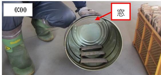
1 炭窯缶の底にタールが溜まるため、短い材でロストルを設置します。炭窯缶は横置きしたとき窓のある方が上。
