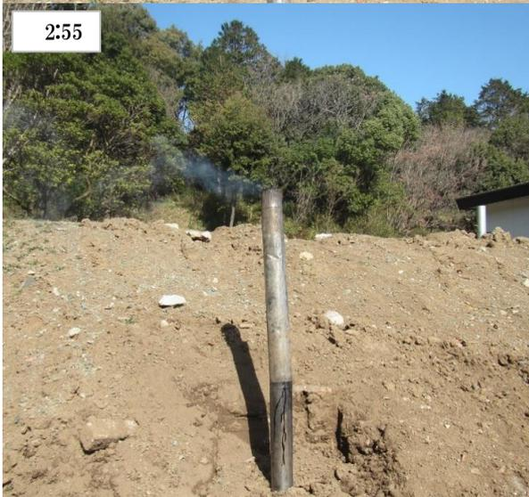
14 白いもくもくとした煙から青いさらっとした煙に変わり、さらにほぼ透明の煙になったら、2~3分間焚口を開けて(ネラシ)、その後焚口と煙突を完全に塞ぎます。窯止めです。
