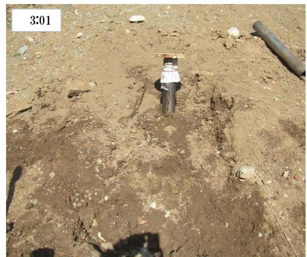
15 煙突は濡らした新聞紙を巻き付けて、上から板で押さえます。焚口も完全に土で埋めてしまいます。
