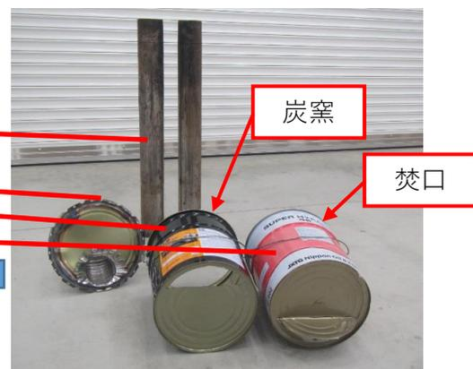
5 炭材を詰めた炭窯缶を焚口缶に入れます。炭窯缶の窓は上に、焚口缶の窓は下になるように設置します。焚口缶の窓は60~90° くらい開けておきます。
