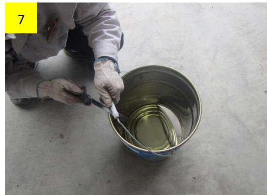
取手などについているプラスチックは外しておきます。熱で溶けるため。(次の炭窯缶も同じ。)
