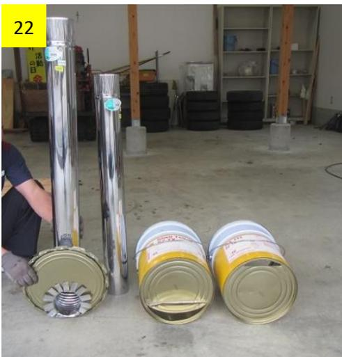
部品の完成です。左からエルボ付き蓋、煙突、焚口缶、炭窯缶。実際は炭材を詰めてから組み立てますが、仮に組み立ててみます。
