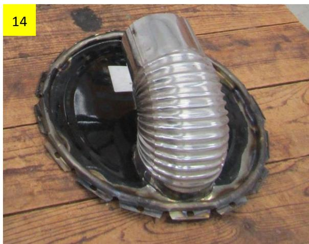
炭窯缶の蓋に市販のエビ曲がり管（エルボ）を取り付けて排煙口を作ります。
