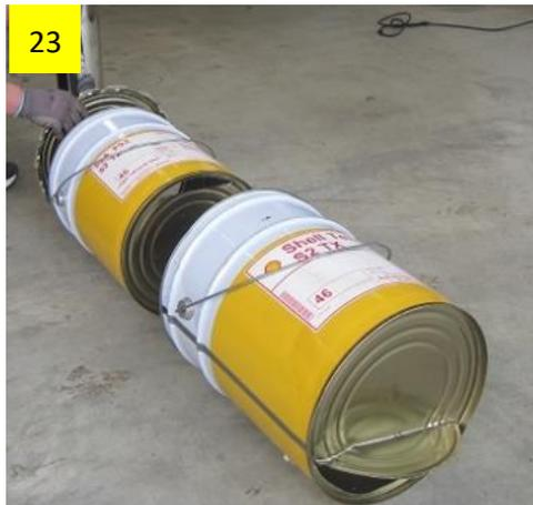
写真のように奥の炭窯缶は窓を上、手前の焚口缶は窓を下にします。取手は両方とも上にあげておきます。(土に埋めて使うので、取手が上にあると取り出しやすい。)
