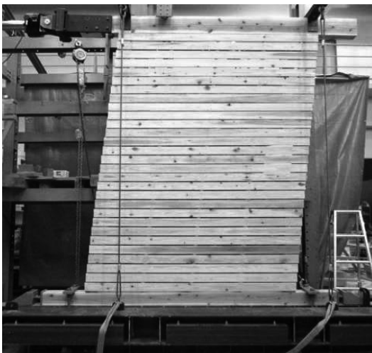
最大変形角時全体 (-1/10変形時)
