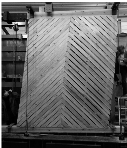
最大変形角時全体 (-1/10変形時)
