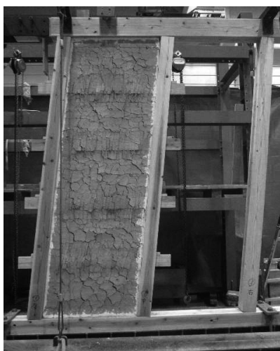
最大変形角時全体 (-1/10変形時)
