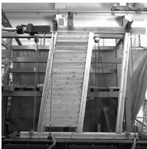
最大変形角時全体 (-1/10変形時)
