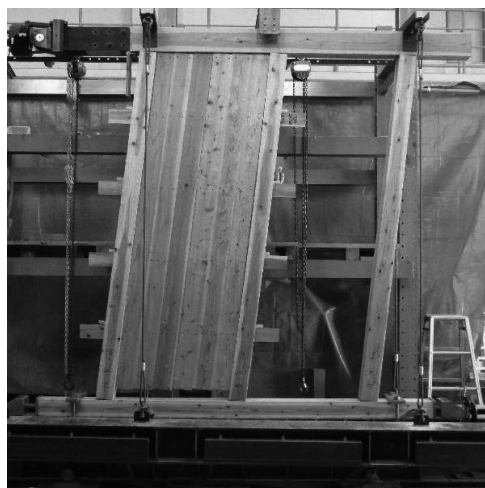
最大変形角時全体 (1/10変形時)
