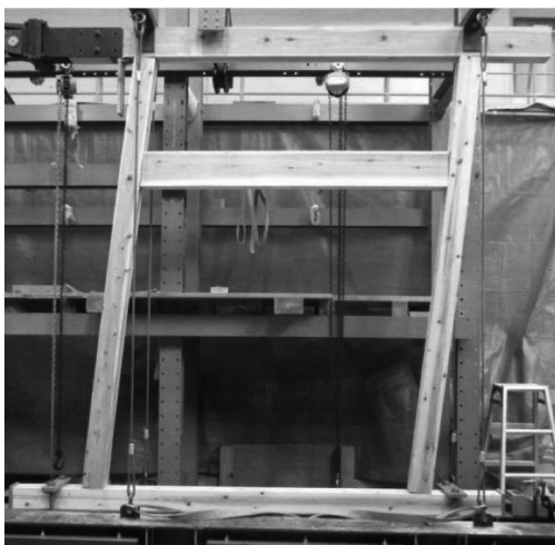
最大変形角時全体 (-1/10変形時)
