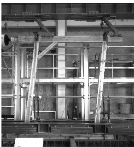
最大変形角時全体 (-1/10変形時)
