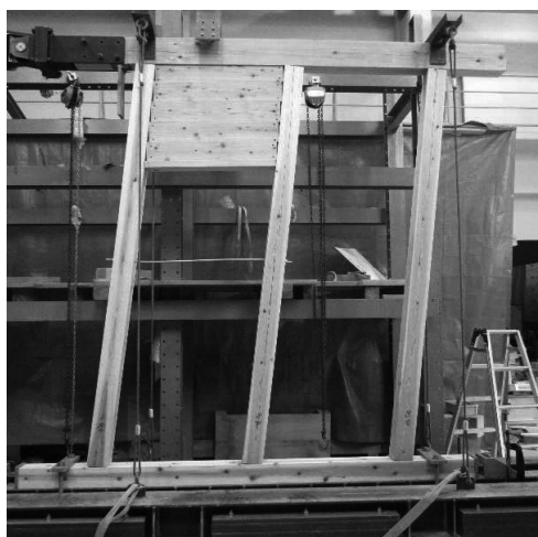
最大変形角時全体 (-1/10変形時)
