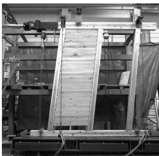
最大変形角時全体 (-1/10変形時)
