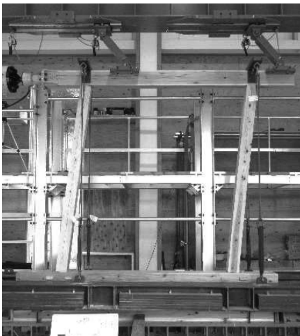
最大変形角時全体 (1/10変形時)
