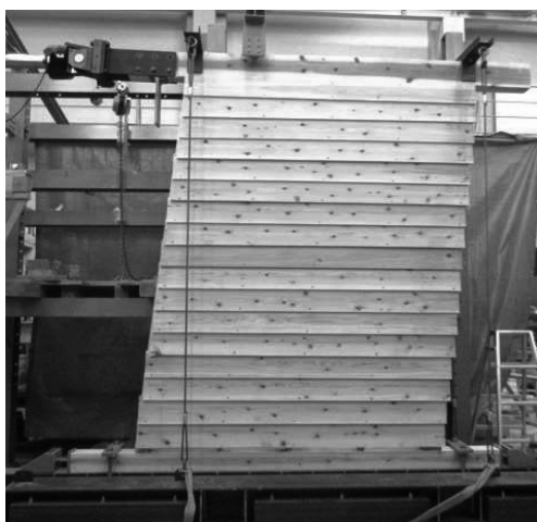
最大変形角時全体 (1/10変形時)
