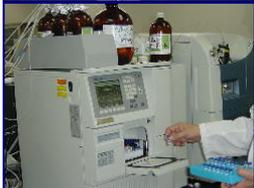
⑧高速液体クロマトグラフ / タンデム型質量分析装置（LC/MS/MS）を用いて、動物用医薬品の測定を行います。
