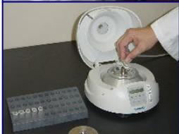
⑦抽出液を一定の量に調整し、浮遊物を沈殿させるため高速遠心分離します。
