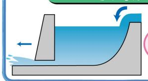
上流から流れ込む量が増え ても、ダムによってため込み、 下流へ流す量を減らします。
